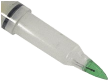
Tulejka do pomiarów w substancjach półstałych
