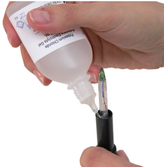
Uzupełnianie elektrolitu żelowego w kołnierzu elektrody
